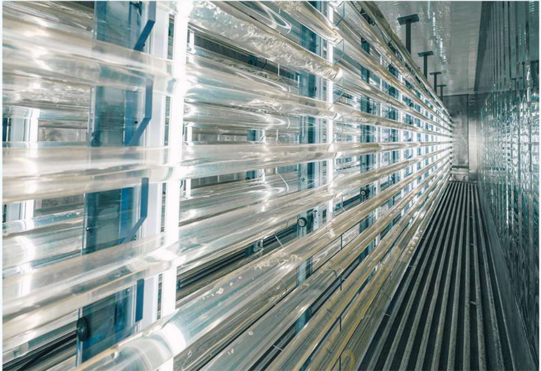
Opstelling waarin algen worden gekweekt die dienen als voeding voor de oesters
